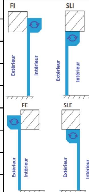
Les côtes sont à donner en millimètres - Le côté manœuvre est à donner vu de l'intérieur de la maison
